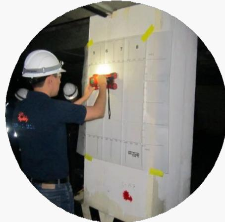
a. Levantamiento con sistemas de detección en elementos de concreto armado
