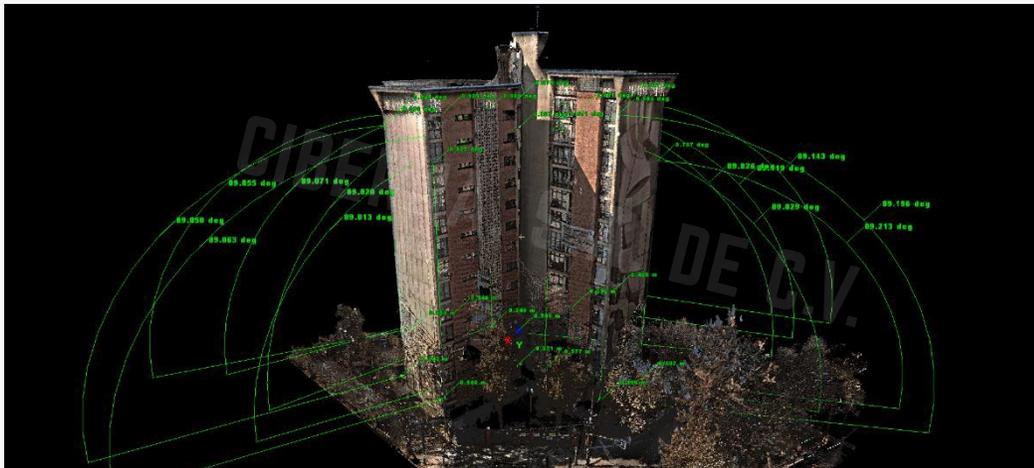
La medición de desplomos la podemos llevar a cabo con la altura de las columnas de entresuelo o con altura total de construcción, esto facilita un estudio de la edificación en su conjunto.
