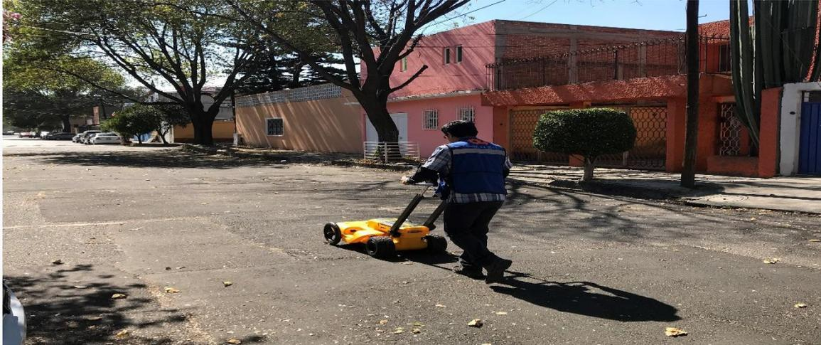
El levantamiento es mediante una técnica no invasiva, la cual consiste en pasar el GPR sobre la superficie donde se cree que están enterrados los servicios públicos (líneas de gas, luz, sanitarias, fibras óptica, etc.). Las ondas electromagnéticas de transmisión son las encargadas de aproximarnos a la ubicación de los objetos ya que estas son reflejadas al momento de alcanzar los objetivos y son captadas en nuestro software de adquisición de datos.
