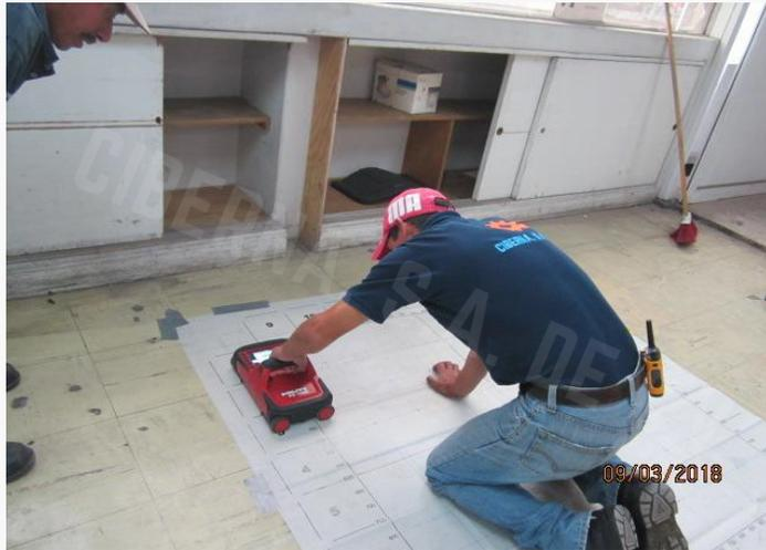
La captura de datos consiste en colocar el equipo directamente sobre los elementos estructurales y tomar muestras representativas (600x600mm o 1200x1200mm) para conocer los objetos incrustados en el concreto.
