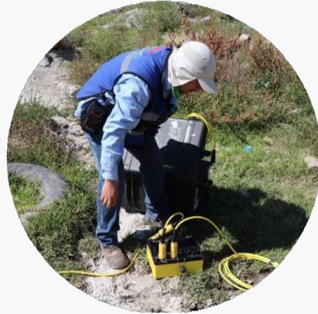
a. Levantamiento con equipo de resistividad
