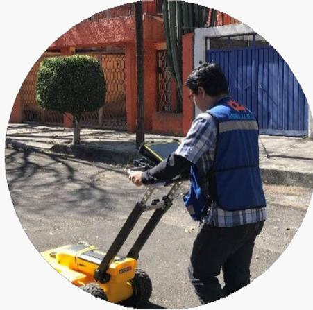
a. Levantamiento con radar de penetración terrestre (GPR) y con localizador de cables.
