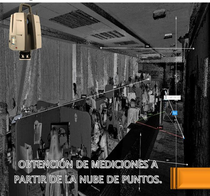
OBTENCIÓN DE MEDICIONES A PARTIR DE LA NUBE DE PUNTOS.
